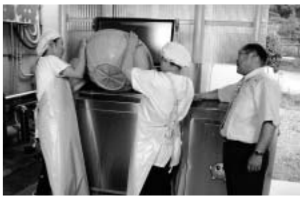
給食室に設置された生ごみ処理機（津久見市立第二中学校）
